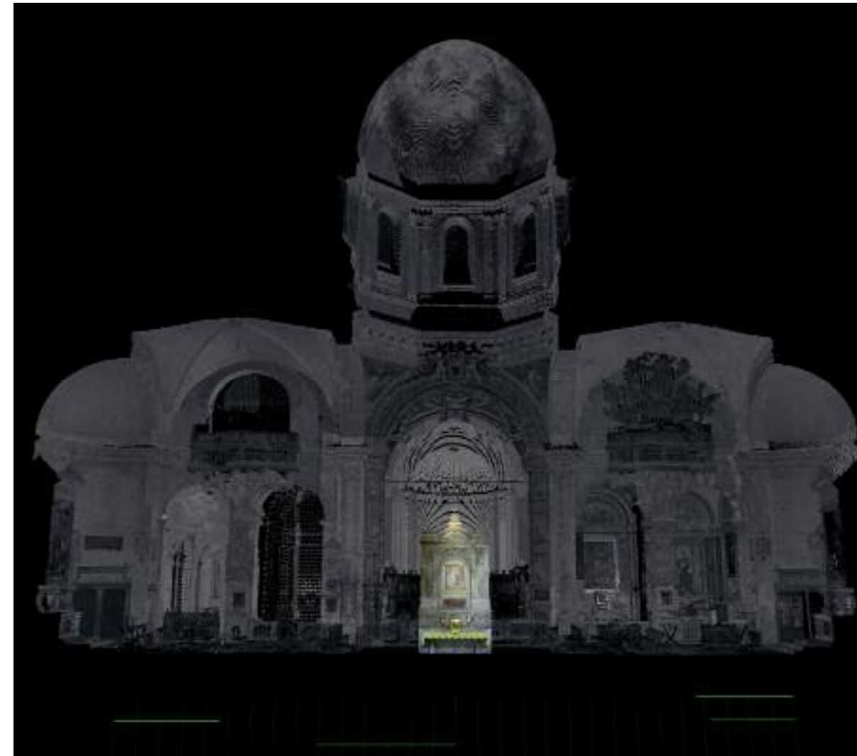
Figura 14. Rilievo tridimensionale in visualizzazione grayscale della chiesa di Santa Maria del Popolo. All'altezza del transetto, la ricollocazione virtuale dell'altare con l'ancona di Andrea Bregno rende evidente l'apertura visuale, dalla parte del transetto e dalla navata, del coro sistemato da Bramante con la calotta a conchiglia di chiusura, oggi nascosto dal monumentale altare seicentesco (figura 13).
