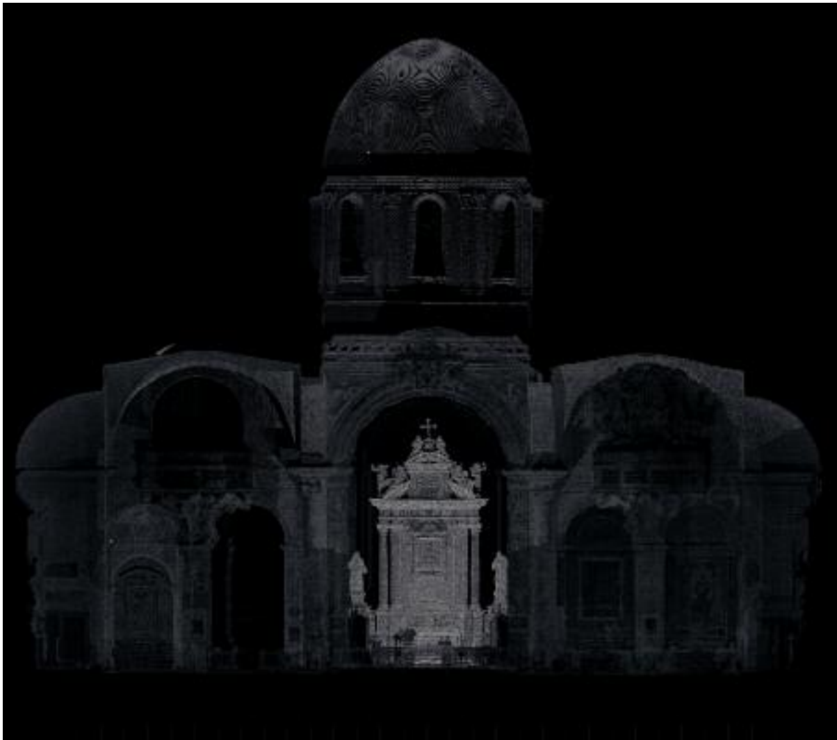
Figura 13. Rilievo tridimensionale in visualizzazione grayscale della chiesa di Santa Maria del Popolo. Spaccato trasversale lungo il transetto.
