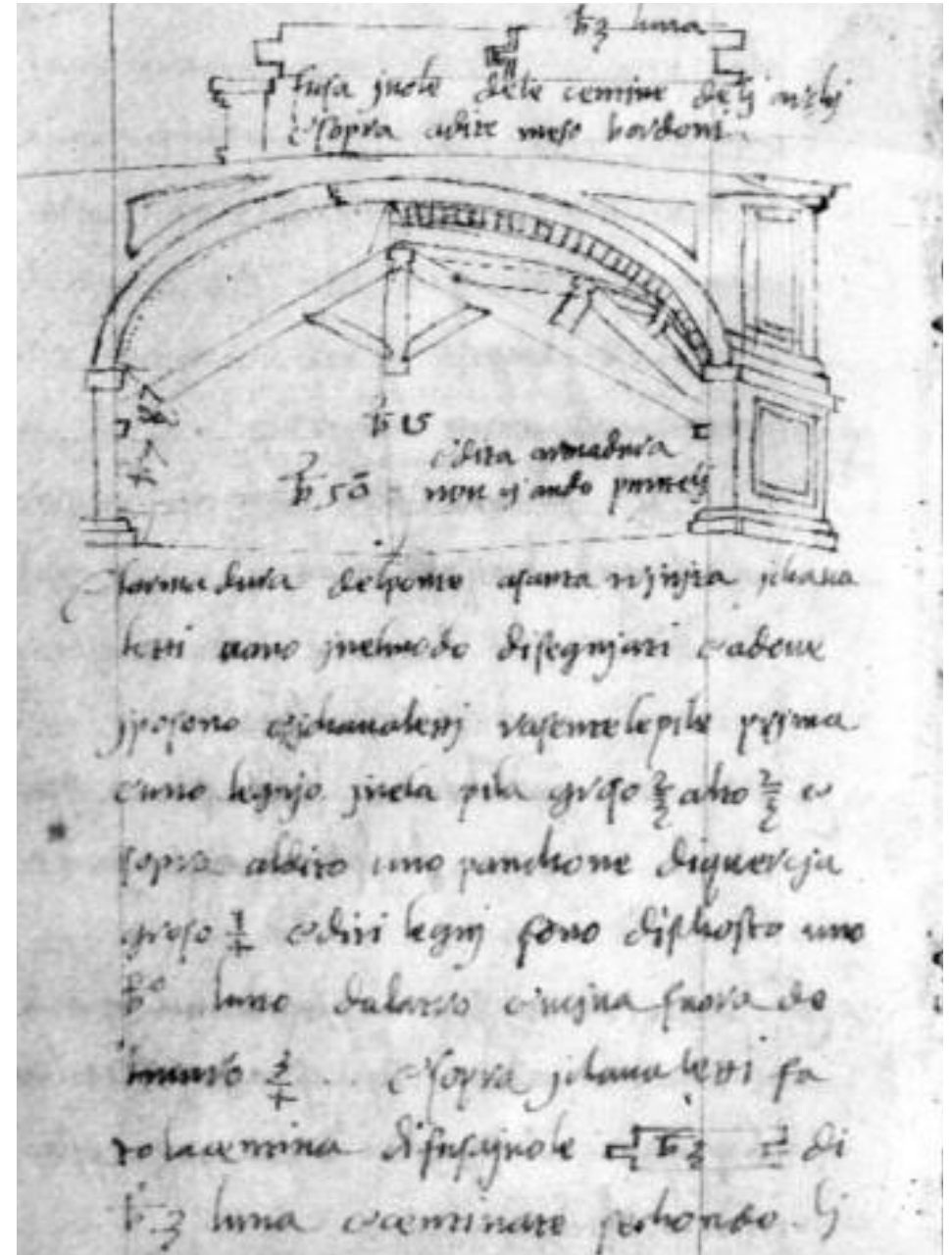
Figura 19. Alfonso Parigi il Vecchio, Armatura lignea del ponte a Santa Trinita , disegno da M. Fossi, Il Taccuino di Alfonso, Giulio, Alfonso il Giovane Parigi , Firenze 1975.
