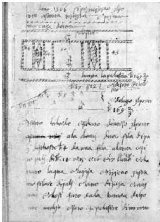
Figura 14. Alfonso Parigi il Vecchio, Pianta delle fondazioni del ponte a Santa Trinita, disegno da M. Fossi, Il Taccuino di Alfonso, Giulio, Alfonso il Giovane Parigi , Firenze 1975.
